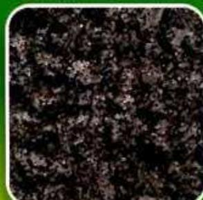
**ECOTAR-A (ECOTAR-A BIO)** – очистка воды от растворенного железа, комплексных железоорганических соединений, марганца, солей жесткости. Рекомендуется для воды из скважин и неглубоких колодцев. Визуальная оценка: вода имеет желто-бурую окраску, при отстаивании образует осадок.
